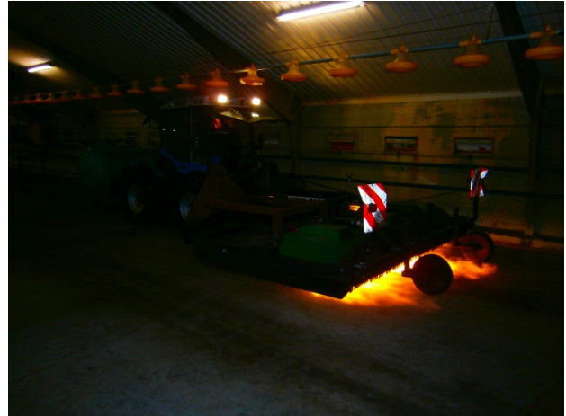
Billede 3. Udstyr fra Varde Maskinstation under flambering af gulv i kyllingehus. Billede 4. Flambering af gulv i kyllingehus.
