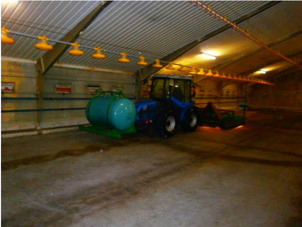
Billede 3. Udstyr fra Varde Maskinstation under flambering af gulv i kyllingehus. Billede 4. Flambering af gulv i kyllingehus.
